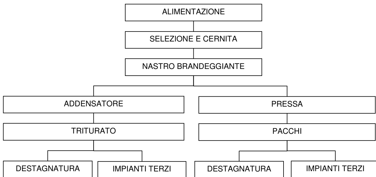
Schema 1 – Schema a blocchi linea di selezione e cernita – Area G
